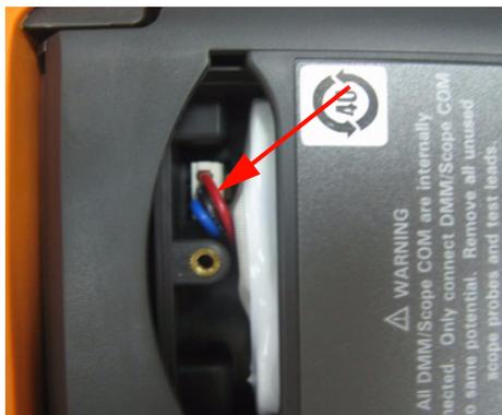
图 8-6 使用镊子拔下三线连接器。
