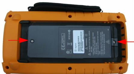
图 8-3 拆卸电池盖螺丝
