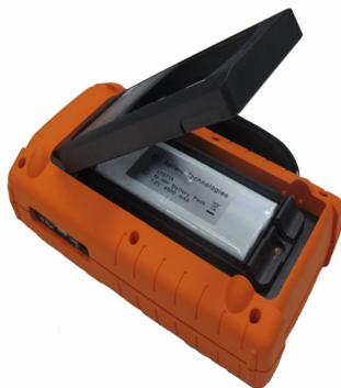
图 8-5 在不拆除底座的情况下拆除电池组
