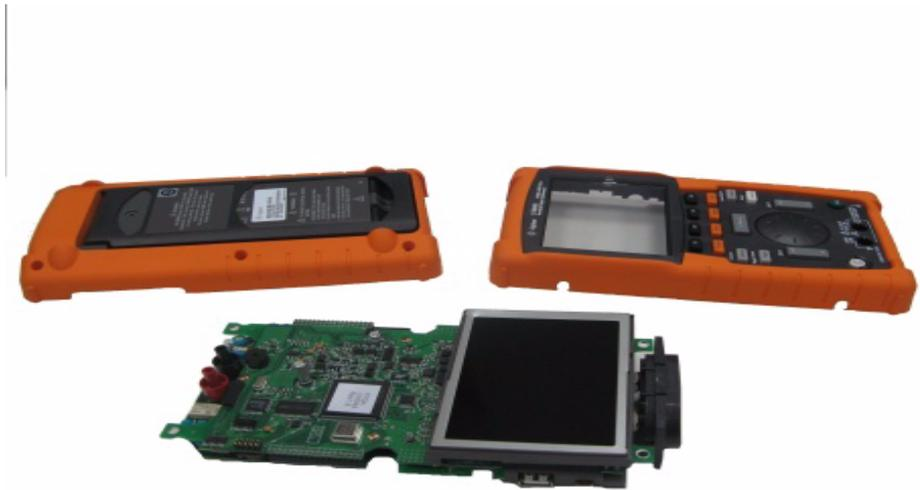
图 8-10 从仪器的 PCBA 拆除前盖（右侧）和后盖（左侧）
